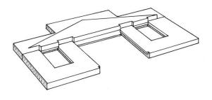
Assemblage des fenêtres (colle cyanoacrylate). Assemblage van de ramen (cyanoacrylaat lijm). Windows assembly (cyanoacrylate glue).
